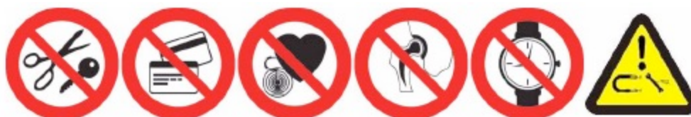
Pictogrammes signalant la présence d'un champ magnétique intense (Source : User Guide Version 4, BRUKER BIOSPIN)
